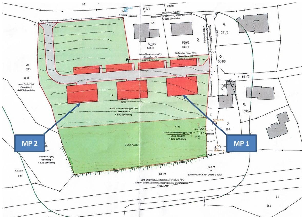
Lage der Messpunkte am Lageplan der geplanten Bebauung
