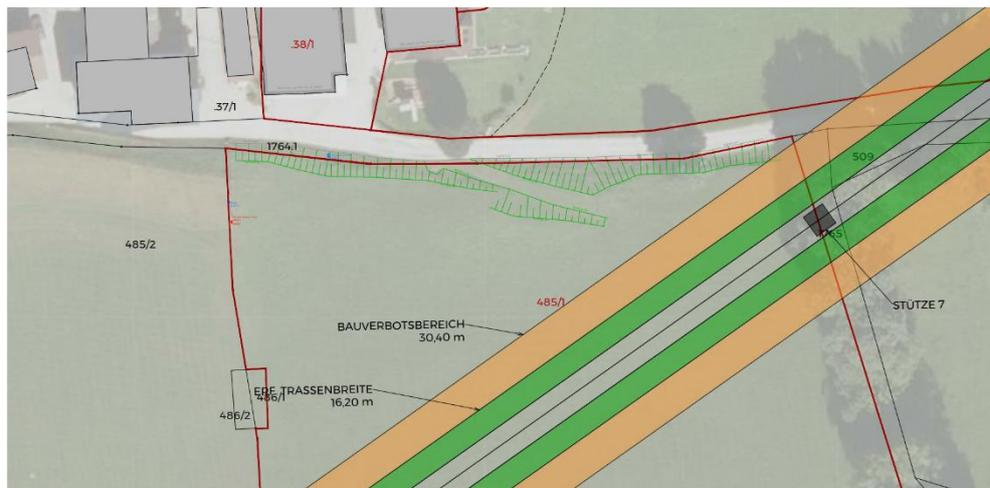
Abbildung des Bauverbotsbereiches des neu geplanten Schiliftes (Ausrichtung Südost), Grafik: GMP Architektur, unmaßstäblich.
